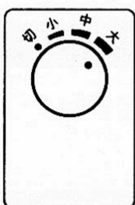
音量切替スイッチを設定することで「大」「中」「小」の3段階に切り替えることができます。
